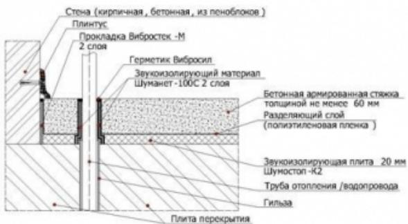
При устройстве конструкции звукоизоляционного пола применяются следующие материалы:
