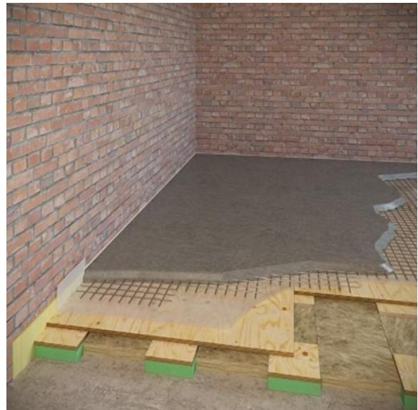
**Площадь: 13 м<sup>2</sup>****Толщина конструкции: 150 мм****ΔLnw ~ 38 дБ**
